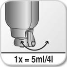
Gire la palanca y dosifique en función de la aplicación y el grado de suciedad.
