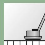
Pulire il pavimento con una monospazzola e un tampone verde o una spazzola per strofinare.
