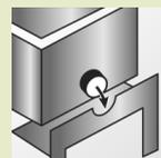
Öffnen Sie den Karton an der dafür vorgesehen Markierung auf dem Karton und setzen den Auslass korrekt in den Halter.
