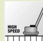
Nach ausreichender Trockenzeit (ca. 1 Tag) mit Ultra-High-Speed-Maschine (>1000 U) polieren.
